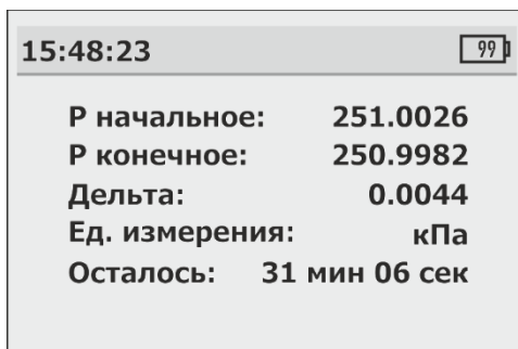
Р и с у н о к 14 – Внешний вид дисплея при активном режиме проверки герметичности.
