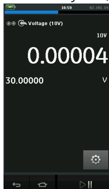
Рисунок 2-18 Измерение напряжения постоянного тока (10 В) на канале 1 (CH1)
