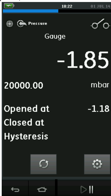
Рисунок 2-8 Пример утилиты Тест реле (Switch Test)
