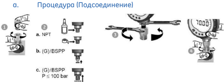
Рисунок 2-2 Подсоединение / отсоединение приборов давления
