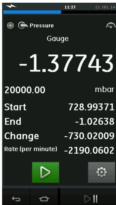
Рисунок 2-20 Пример утилиты Тест герметичности (Leak Test)
