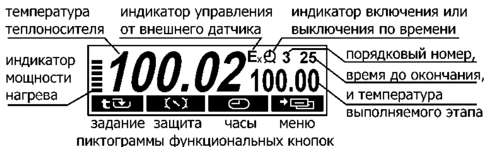
Рисунок 4 — Дисплей в режиме регулирования по программе
