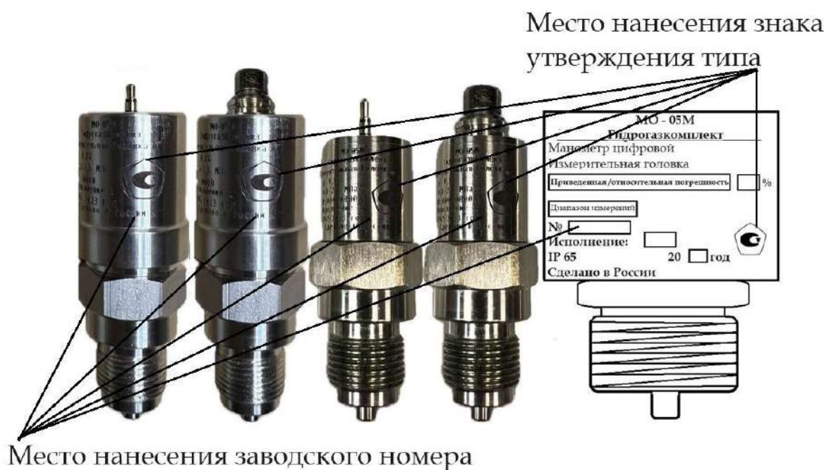
Рисунок 9 – Общий вид ИГ и место нанесения знака утверждения типа и заводского номера для исполнений 1, 5, 5МС, 8, 8МС
