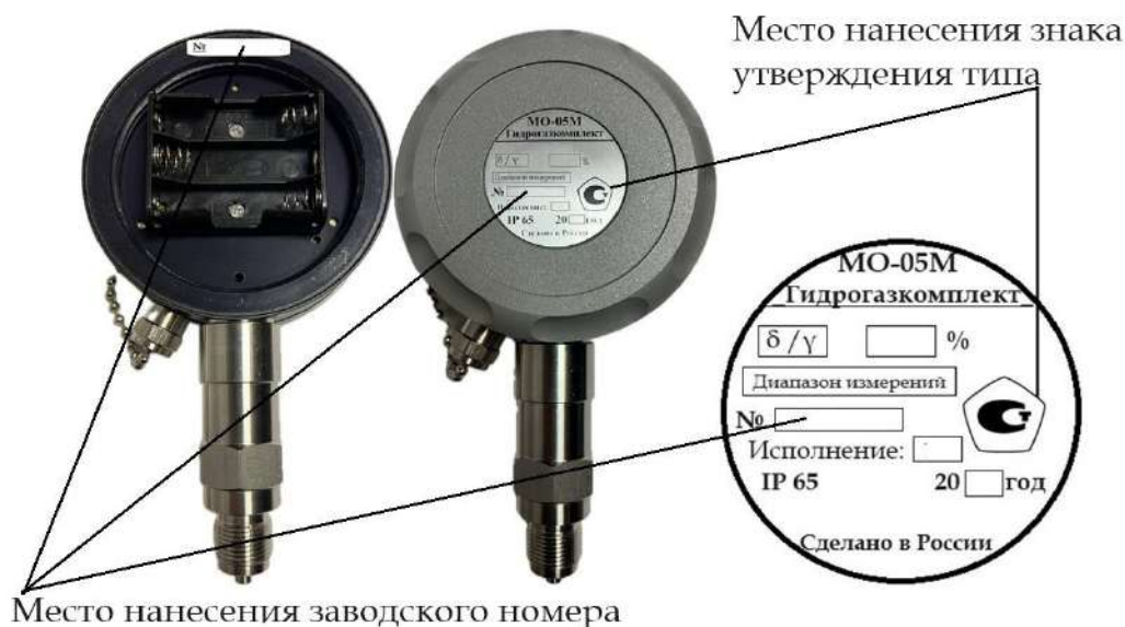
Рисунок 8 – Место нанесения знака утверждения типа и заводского номера для исполнений 2, 3, 4, 4МС, 6, 6МС, 7, 7МС.
