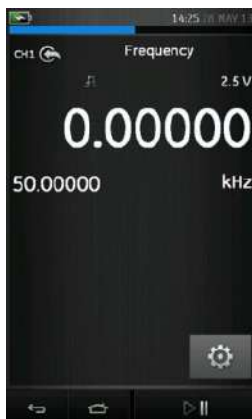
Рисунок 2-17. Пример А, измерение частоты на CH1 (диапазон 0—50 кГц)
