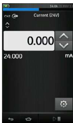
Рисунок 2-15. Генерация тока на CH2 на внутреннем контуре питания (диапазон: 0—24 мА)
