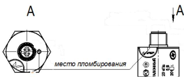
Рисунок 3 – Схема пломбировки от несанкционированного доступа ПДЭ-020
