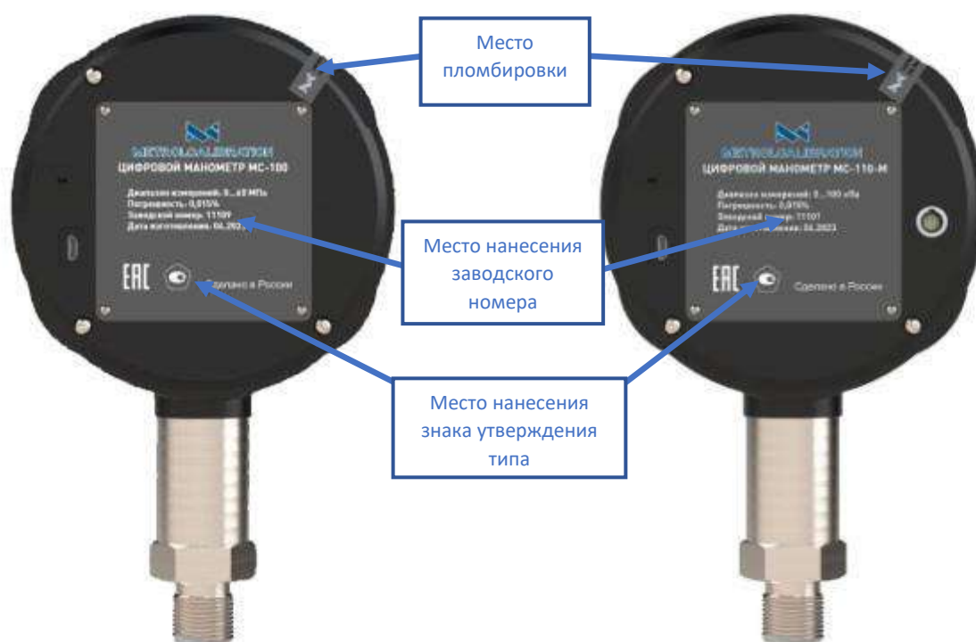
Рисунок 3 – Места пломбировки, нанесения знака утверждения типа и заводского номера
