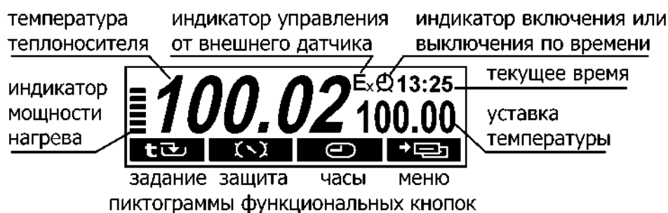
Рисунок 3 — Дисплей в режиме регулирования по уставке
