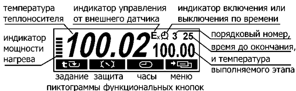
Рисунок 4 — Дисплей в режиме регулирования по программе
