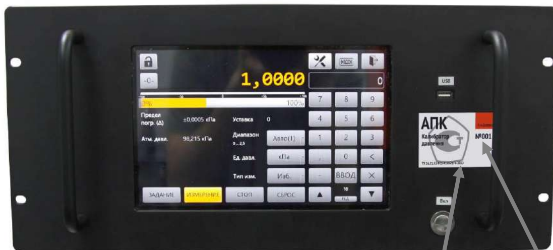
Рисунок 3 – Лицевая панель калибратора
