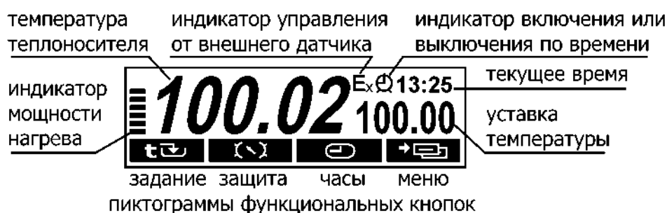
Рисунок 4 — Дисплей в режиме регулирования по уставке
