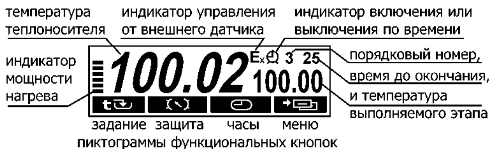
Рисунок 5 — Дисплей в режиме регулирования по программе
