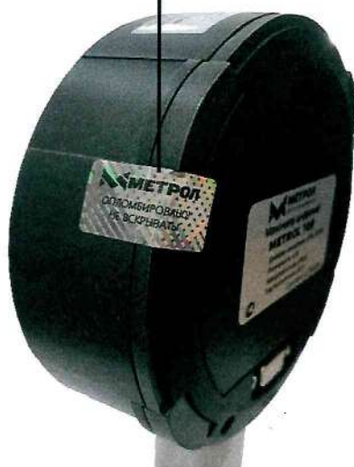
Рисунок 3 - Схема пломбировки цифровых манометров METROL 1X0 от несанкционированного доступа
